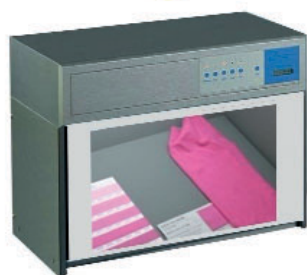
6. ábra. Színek vizuális összehasonlítására alkalmas eszköz
