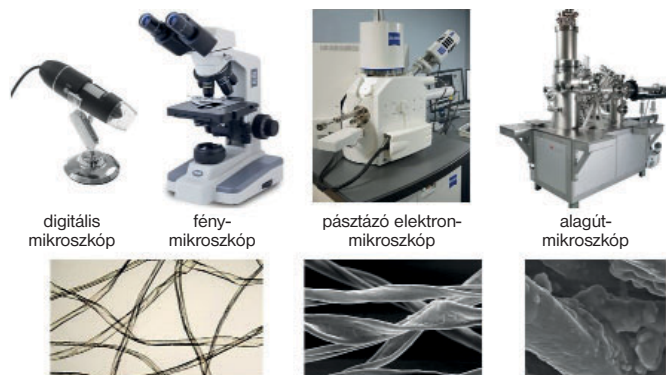
4. ábra. A vizuális vizsgálatokhoz különböző mértékű nagyításokra alkalmas eszközök
