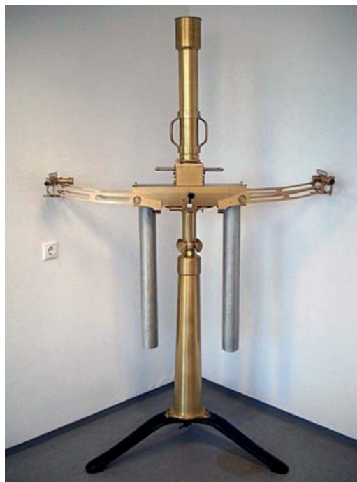
4. ábra. Az Eötvös-féle torziós inga egyik változata, az ún. kettős inga (amelynek két függőleges karja van)
