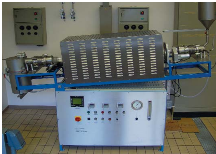
6. ábra. Szénnanocsövek előállítására szolgáló forgó csökemence [31]
