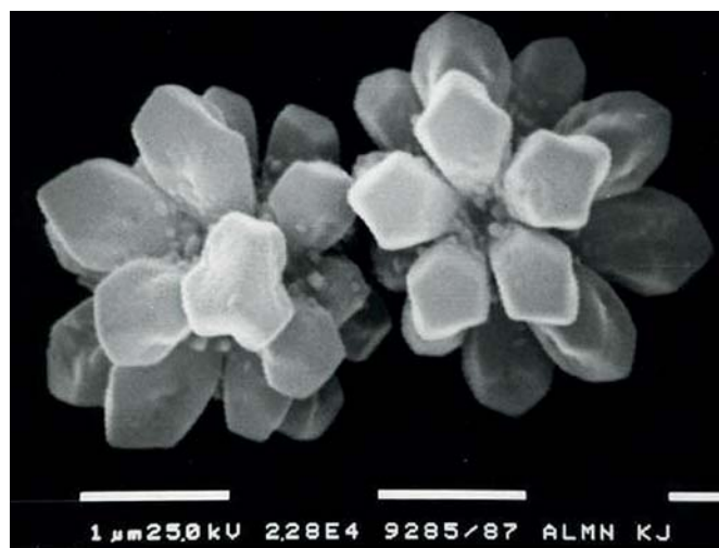
2. ábra. A mátrix feloldása útján izolált AlMn-kvázikristályok SEM-felvétele (ez a felvétel jelent meg a Materials Science Forum 1987-es 22–24. számának előlapján)
