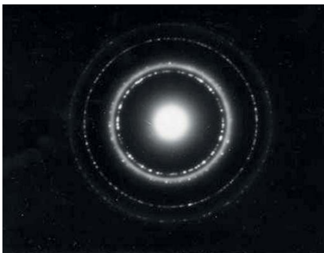
5. ábra. Az Al_{69}Mn_{31} összetételű, 42 nm öszsvastagságú, szoba-hőmérsékletű (RT) hordozóra párologtatott vékonyrétegmintában, 630 °C-on, vákuumban ( 10^{-4} Pa) in situ hőkezelés során kialakuló T-fázis transzmissziós elektronszkópos felvétele és jellegzetes diffrakciós ábrái
