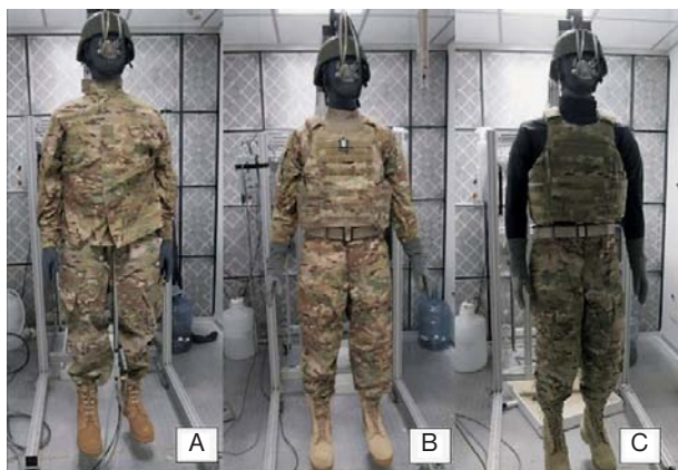
14. ábra. Különböző testpáncéllal ellátott védőöltözékek ruházatfiziológiai vizsgálata szenzoros bábun
