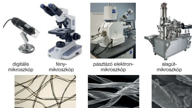
4. ábra. A vizuális vizsgálatokhoz különböző mértékű nagyításokra alkalmas eszközök
