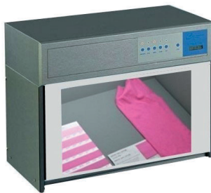
6. ábra. Színek vizuális összehasonlítására alkalmas eszköz
