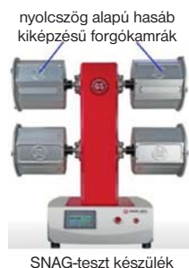
4. ábra. A száلكihúzóási hajlam forgókamrás vizsgálata
