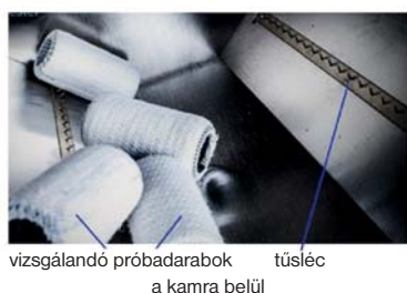
4. ábra. A száلكihúzóási hajlam forgókamrás vizsgálata
