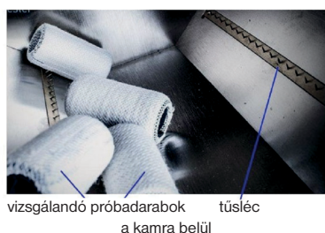
4. ábra. A száلكihúzóási hajlam forgókamrás vizsgálata
