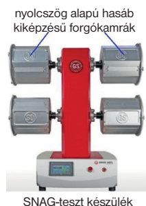
4. ábra. A száلكihúzóási hajlam forgókamrás vizsgálata
